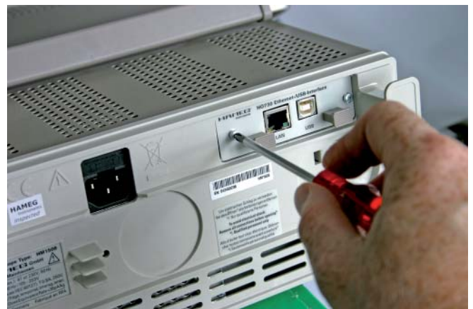
5.2.2 Befestigen Sie das Interface mit den vorher entfernten (Punkt 5.1.1) Befestigungsschrauben.
