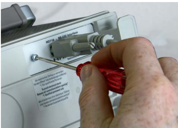
5.1.1 Entfernen Sie die beiden Befestigungsschrauben.
